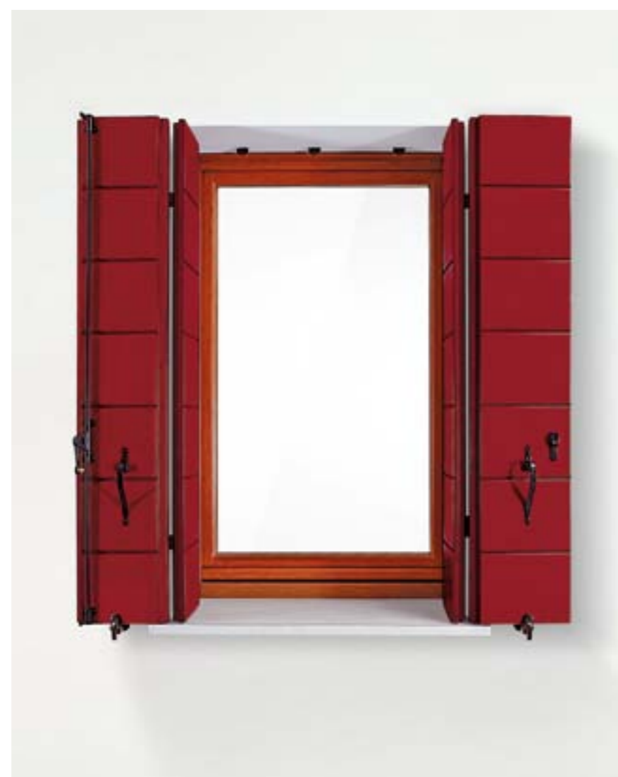
Serramento anta unica e scuro S40 in multistrato okoumè laccato RAL 3004, apertura alla padovana. One-Sash door/window and solid Okoumé multi-layered shutter with RAL 3004 enamel, Padoan opening style.
